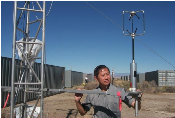
Рисунок 1.5 – Акустический анемометр, размещённый на 6-метровой вышке, и часть участка с массивом контейнеров [35]
