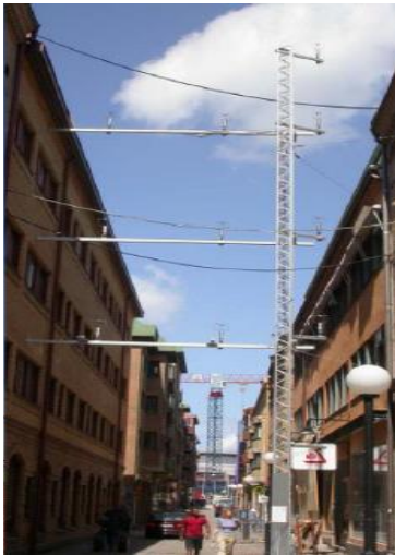
Рисунок 1.2 — Фотография метеорологической мачты и инструментов измерения в каньоне [22] (слева); почасовое среднее поле ветра в уличном каньоне в плоскости Oxz (справа); в верхнем левом углу указывается текущее время (в часах), а контурные линии – это интерполированные значения компоненты вектора скорости V
