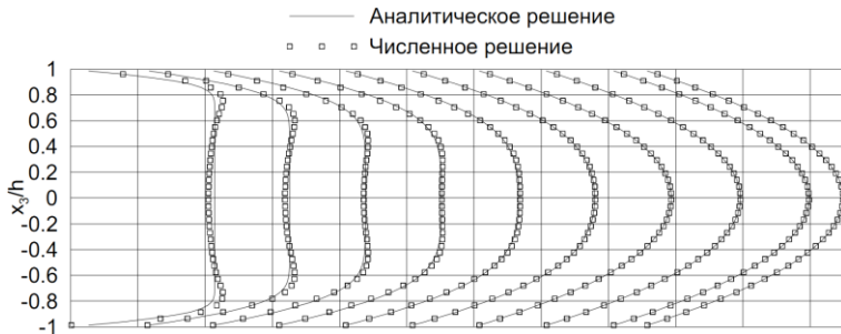
Рисунок 3.6 – Распределение осевых скоростей ламинарного течения в начальном участке канала, образованного параллельными пластинами ( \text{Re} = 200 )
