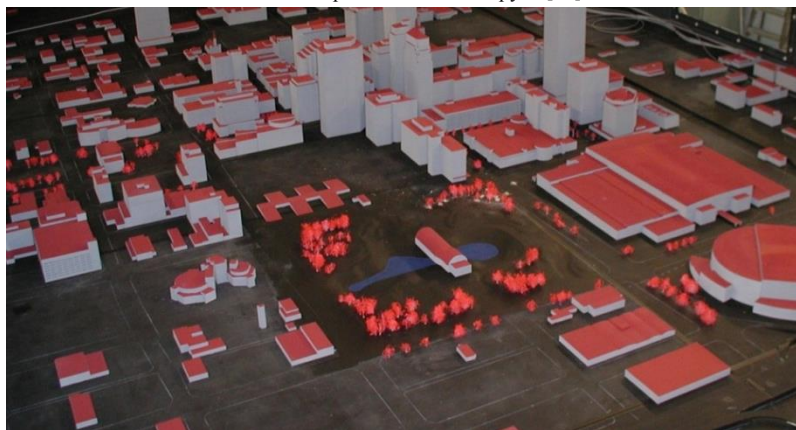
Рисунок 1.9 – Модель городской застройки URBAN 2003 эксперимента в аэродинамической трубе [31]
